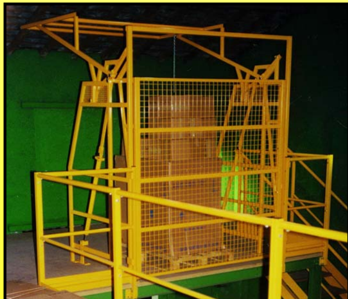
A29 Protection rigide grillagée en façade.
